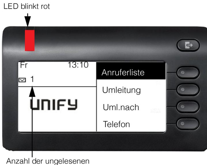
Wenn Sie den Softkey oben rechts auf dem Gerät drücken, wird der folgende Bildschirm angezeigt:
